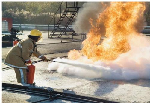
Algumas técnicas de combate a incêndios consistem em evitar o contato do gás oxigênio do ambiente com o combustível das chamas. Essa é a função dos extintores de incêndio à base de gás carbônico, que espalham CO<sub>2</sub> sobre as chamas. Desse modo, evita-se que o gás oxigênio entre em contato com o combustível e a combustão é interrompida.
