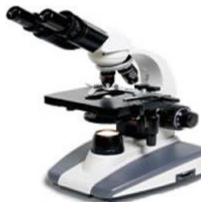
Este microscópio composto também é chamado Microscópio Óptico sendo capaz de aumentar até 2 000 vezes o objeto observado. Existem também Microscópio Eletrônicos capazes de proporcionar aumentos de até 100 000 vezes e Microscópios de Varredura que produzem aumentos superiores a 1 milhão de vezes.
