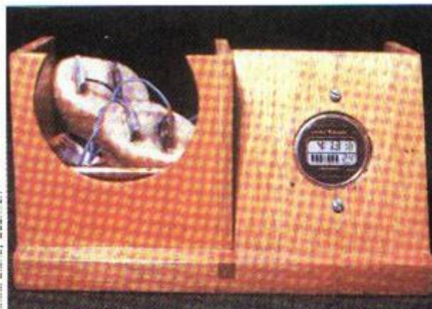
O Relógio Digital está funcionando com uma pilha feita de duas lâminas, uma de zinco e outra de cobre, enfiadas numa batata.
