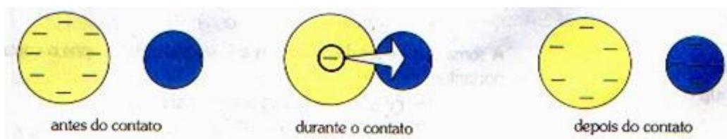
As cargas em excesso do condutor eletrizado negativamente se repelem e alguns elétrons passam para o corpo neutro, fazendo com que ele fique também com elétrons em excesso e, portanto, eletrizado negativamente.
