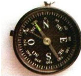
A bússola é constituída essencialmente por um pequeno ímã, em forma de agulha, apoiado de modo a poder girar livremente em torno de seu centro (figura ao lado). O polo norte magnético da agulha (designado por N) é aquele que aponta para o norte geográfico, e seu polo sul magnético (designado por S) é o que aponta para o sul geográfico.
