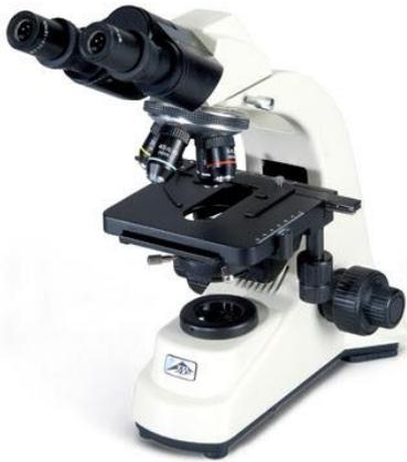
O microscópio óptico é dotado de duas lentes de vidro ou de cristal e fornece ampliações de até 1.000 vezes do objeto visualizado.
