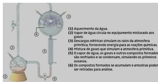
O Esquema do equipamento montado por Miller para testar a teoria de Oparin-Haldane. O sistema imitava as condições da atmosfera primitiva da Terra.
