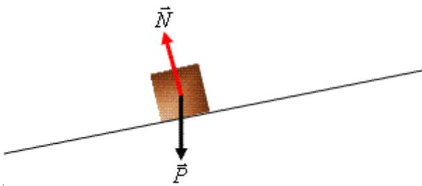
A força Peso e a força Normal, neste caso, não tem o mesma direção pois, como já vimos, a força Peso, é causada pela aceleração da gravidade, que tem origem no centro da Terra, logo a força Peso têm sempre direção vertical. Já a força Normal é a força de reação, e têm origem na superfície onde o movimento ocorre, logo tem um ângulo igual ao plano do movimento.
